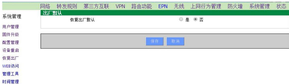
恢复出厂默认，是指清空设备里的所有配置信息，将其恢复到出厂状态，重新配置，相当于设备面板上的 reset 键功能。
