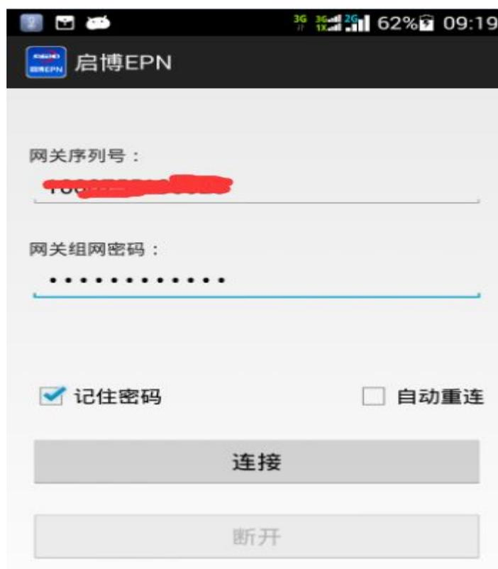
输入需要连接的 EPN 网关序列号和组网密码，点击连接，为了方便下次使用，可勾选 记住密码选项。显示下图表示 EPN 连接成功，如果连接失败会给出相应的提示信息。
