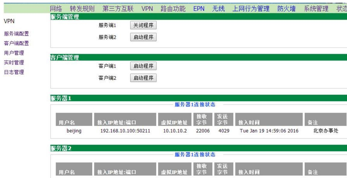
VPN 服务器的连接状态上显示在线用户及他们连接时公网 IP、连接端口，隧道 IP、备注，一目了然非常直观。
