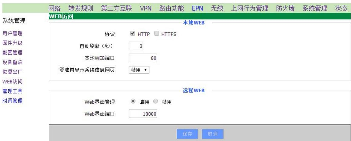
本页面设置启博 VPN 网关的 WEB 管理端口和广域网中可以管理的端口，本地 WEB 是指通过 VPN 网关的 LAN 接口访问设备，远程 WEB 是指通过 VPN 网关的 WAN 接口访问设备。
