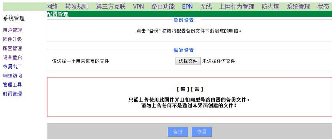
用户可以将设备的配置导出，以防万一可将此配置重新导入该设备或导入新的设备，达到快速恢复设置的目的。
